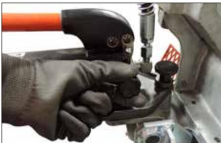
**21.** Tourner la vanne de la pompe à main hydraulique **dans le sens anti-horaire** pour ouvrir la vanne et libérer le tube.
