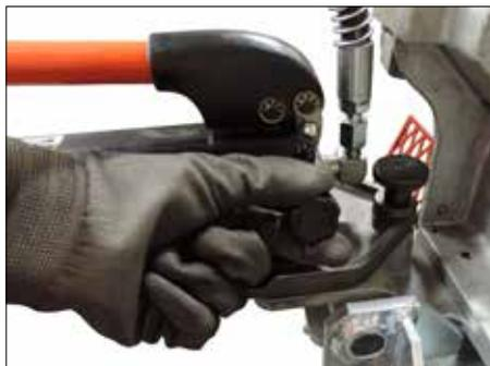
**3.** Vérifier que la pompe est exempte de pression résiduelle en tournant la vanne de la pompe **dans le sens anti-horaire** pour ouvrir la vanne.
