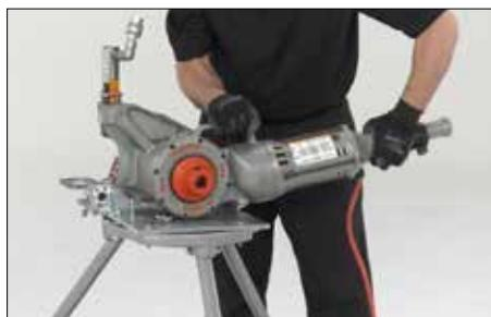
1. Placer le bloc d'entraînement Ridgid 700 sur la partie arrière du trépied. Aligner le trou taraudé du corps du bloc d'entraînement Ridgid 700 avec celui du support de montage sur la plaque de base.
