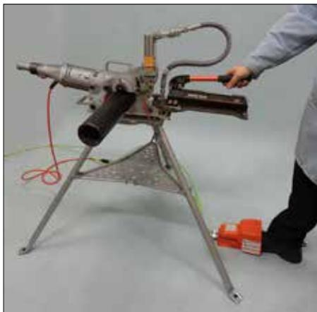
**16.** Lorsque le tube tourne, lancer le rainurage en actionnant lentement et progressivement la poignée de la pompe à main hydraulique. S'assurer que le tube reste appuyé contre la bride-butée de la molette inférieure. Si le tube se déplace, relâcher la pédale de sécurité et repositionner le tube.
