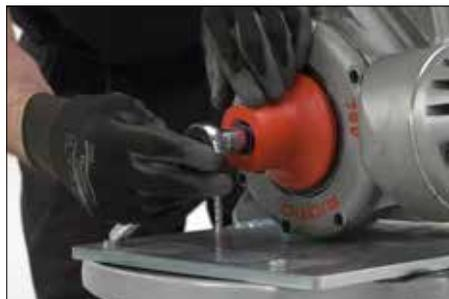
5. Installer et serrer le boulon hexagonal et la rondelle de blocage à l'arrière de l'arbre, à l'aide d'une clé à douille 5/16".
