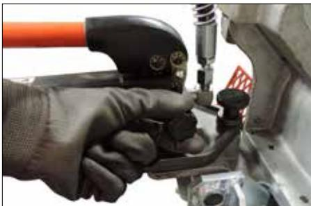
2. Soulever le bras de la molette supérieure à sa position maximale en tournant la vanne de la pompe à main hydraulique **dans le sens anti-horaire** pour ouvrir la vanne.
