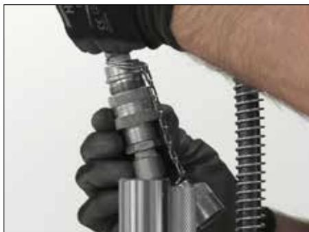
**4.** Retirer le capuchon et installer l'adaptateur de raccord rapide sur celui du vérin hydraulique, serrer à fond. Si la bague n'est pas entièrement insérée et serrée, le clapet anti-retour à bille ne peut pas fonctionner correctement, le fluide hydraulique étant refoulé dans le tuyau.
