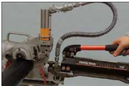
**10a.** Tout en soutenant le tube, actionner la poignée de la pompe à main hydraulique pour faire entrer la molette supérieure légèrement en contact avec le tube.
