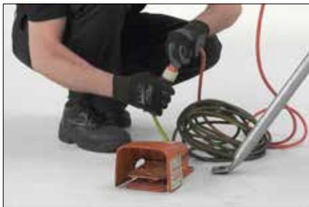
**9.** Raccorder le cordon d'alimentation du bloc d'entraînement Ridgid 700 à la pédale de sécurité, comme illustré ci-dessus. Brancher le cordon d'alimentation de la pédale à une prise de courant mise à la terre. Se reporter au manuel d'utilisation du bloc d'entraînement fourni par le fabricant pour des informations complémentaires.
