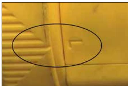
7b. Le corps du Rems comporte les indications **L** (gauche) et **R** (droite). Pour inverser le sens de rotation, tourner la bague afin d'aligner la flèche sur l'indication souhaitée.
