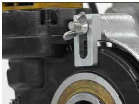
4. Contrôler le matériel de montage pour s'assurer que le support est droit et que le bloc d'entraînement est correctement fixé.
