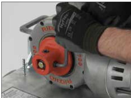
5. À l'aide d'une clé hexagonale 5/16", serrer chaque vis sur l'adaptateur du carré conducteur du bloc d'entraînement Ridgid 700.
