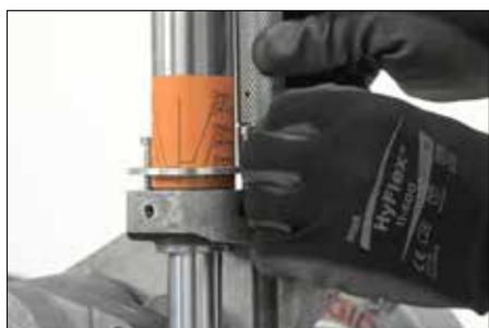
**5.** Faire reculer la butée de diamètre de rainure en desserrant le dispositif de réglage de butée de course.
