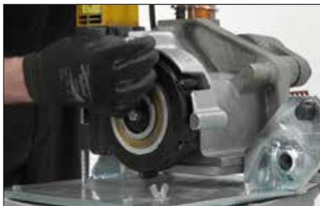
2. Positionner le support de montage sur le boulon de montage, comme illustré.
