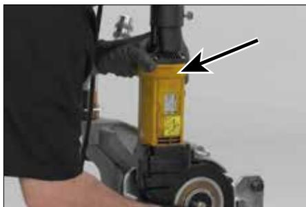
7a. Repérer la bague tournante à la base du corps du Rems.
