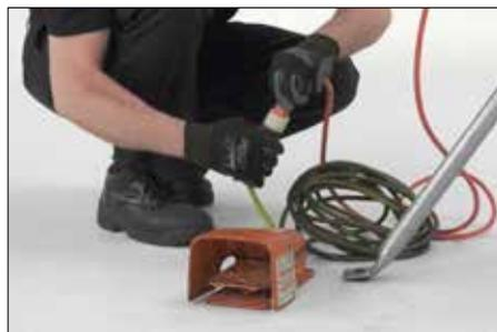
**2.** Raccorder le cordon d'alimentation du bloc d'entraînement à la pédale de sécurité, comme illustré ci-dessus. Brancher le cordon d'alimentation de la pédale à une prise de courant mise à la terre. Se reporter au manuel d'utilisation du bloc d'entraînement fourni par le fabricant pour des informations complémentaires.
