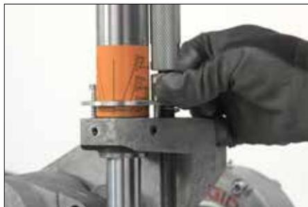
13. Tourner la butée de course pour régler la hauteur de la plaque supérieure d'indication de butée de profondeur.
