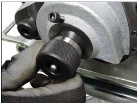
3. Insérer l'arbre supérieur dans la partie moulée du bras et dans la molette supérieure.
