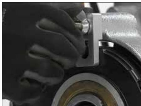
3. Insérer l'écrou à ailettes sur le support de montage et serrer à fond.
