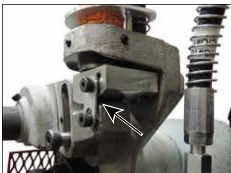
2. Appliquer de la graisse sous le bloc de pivot.
