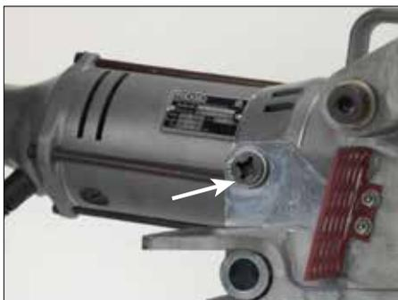
3. Aligner la vis de montage (fixée à la plaque de montage sur le trépied) dans le trou taraudé du corps du bloc d'entraînement Ridgid 700, comme illustré ci-dessus.
