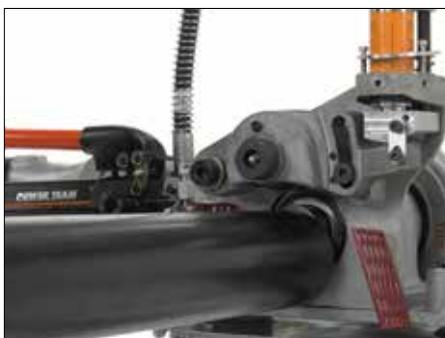
**7.** Insérer une longueur de tube de diamètre et d'épaisseur corrects sur la molette inférieure.
