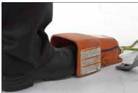
**3.** Appuyer sur la pédale de sécurité. Contrôler que la molette inférieure tourne en s'éloignant de l'opérateur lorsque l'on regarde depuis l'avant de l'outil. Si la molette inférieure tourne en direction de l'opérateur, se reporter à la section du bloc d'entraînement correspondante pour y trouver les consignes à suivre afin d'inverser le sens de rotation. Relâcher la pédale de sécurité.
