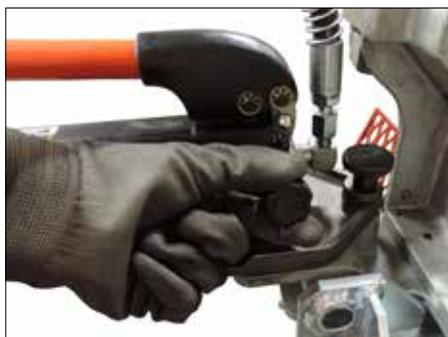
6. Tourner la vanne de la pompe à main hydraulique **dans le sens horaire** pour fermer la vanne.
