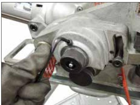
4. À l'aide d'une clé hexagonale  $\frac{3}{16}$ ", serrer la vis pour immobiliser l'arbre supérieur en position. S'assurer que la molette supérieure tourne sans entrave.
