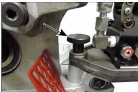
**2.** Serrer la vis à serrage manuel pour immobiliser la pompe à main hydraulique sur la tête porte-outils.
