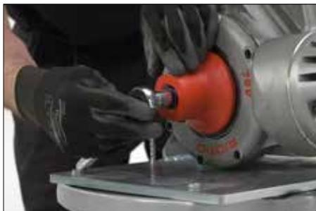
3. Desserrer et retirer le boulon hexagonal et la rondelle de blocage à l'arrière de l'arbre, à l'aide d'une clé à douille  $\frac{3}{16}$ ".
