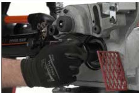
4. Sortir la molette inférieure/l'arbre principal de la partie avant de la tête porte-outils. À l'aide d'un chiffon doux, éliminer tout débris et résidu de graisse de la molette inférieure/l'arbre principal.
