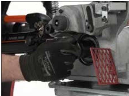
4. Installer la molette inférieure/l'arbre principal dans la tête porte-outils. Tout en maintenant l'extrémité moletée (molette inférieure) de l'arbre principal, s'assurer que les plats sur l'extrémité d'entraînement de l'arbre principal sont alignés avec ceux de l'adaptateur du bloc d'entraînement.
