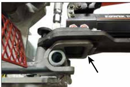
**1.** Positionner la pompe à main hydraulique sur l'une des poignées de levage de la tête porte-outils, en s'assurant que la lèvres de la face inférieure de la plaque de montage de la pompe est alignée avec le bord de la poignée de levage.
