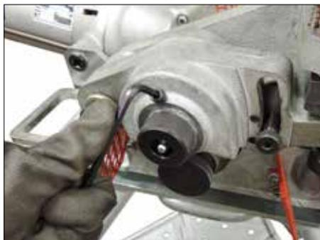
1. À l'aide d'une clé hexagonale  $\frac{3}{16}$ ", desserrer la vis située dans la partie supérieure de la pièce moulée du bras.
