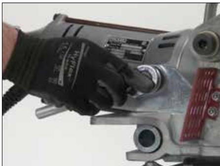
4. À l'aide d'une clé à cliquet avec un carré mâle  $\frac{3}{8}$ " , serrer la vis de montage pour immobiliser le bloc d'entraînement Ridgid 700 sur le trépied.
