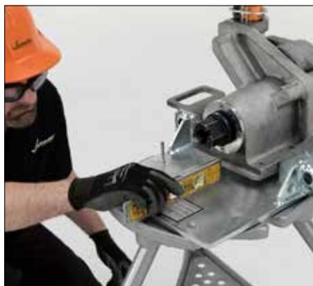
**3.** Serrer chaque vis à serrage à main pour immobiliser la tête porte-outils sur le trépied. S'assurer que les boulons sont serrés de manière uniforme de chaque côté de la tête porte-outils.
