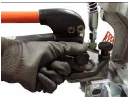
**4.** Tourner la valve de la pompe à main hydraulique **dans le sens anti-horaire** pour ouvrir la valve et lever la molette supérieure pour obtenir un intervalle afin d'insérer le tube.
