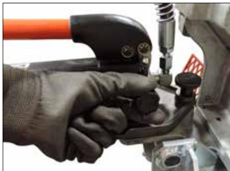
**9.** Tourner la vanne de la pompe à main hydraulique dans le sens horaire pour fermer la vanne.
