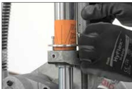
14. Lorsque la plaque supérieure d'indication de butée de profondeur est correctement alignée, serrer l'adaptateur de butée de course pour conserver le réglage.
