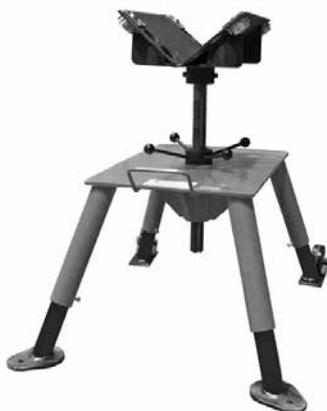
Le support de tube portatif, réglable Victaulic VAPS112, de type rouleur, comporte quatre pieds pour une stabilité renforcée. Les rouleaux de transfert à billes réglables pour tubes de 2 – 12"/60,3 – 323,9 mm et le support « V » pour tubes de ¾ – 1 ½"/26,9 – 48,3 mm permettent un mouvement linéaire et rotatif. La conception à tourniquet facilite le rainurage des deux extrémités de tube. Contacter Victaulic pour en savoir plus.
