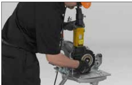
1. Tenir le bloc d'entraînement Rems Amigo 2 Compact avec la poignée-moteur orientée vers le haut. Aligner le coussinet de tige d'entraînement de la tête porte-outils avec la bague de retenue du bloc d'entraînement. Pousser le bloc d'entraînement sur le coussinet de tige d'entraînement.
