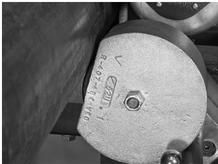
2. À l'aide du volant, faire avancer le rouleau sur le stabilisateur de tube vers l'intérieur de façon à ce qu'il soit à environ  $\frac{1}{16}$  po/1,5 mm du tube. Voir la Figure 2 pour le positionnement correct.
