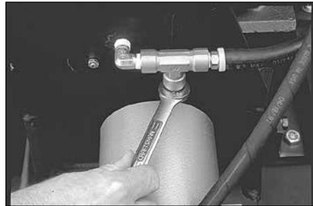
2. Déposez le bouchon de vidange de la conduite hydraulique adjacente au réservoir. Laissez l'huile s'écouler dans un contenant de 6 litres (1  $\frac{1}{2}$  gallon) ou plus.
