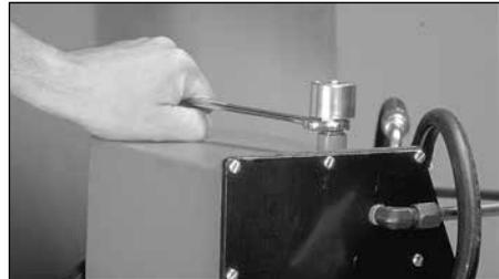
1. Déposez le bouchon du reniflard du dessus du réservoir hydraulique.
