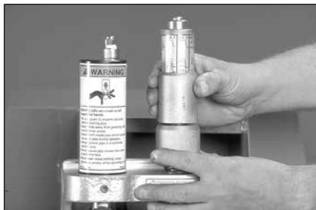
3. Réglez la butée de profondeur de rainure en fonction du diamètre et de l'épaisseur du tuyau à rainurer indiqué sur l'échelle en tournant le barillet de verrouillage du régulateur de profondeur de rainurage vers la gauche et en alignant le régulateur à la marque adéquate de diamètre et d'épaisseur, et puis bloquez en place le dispositif de réglage de profondeur à l'aide du barillet de verrouillage.
