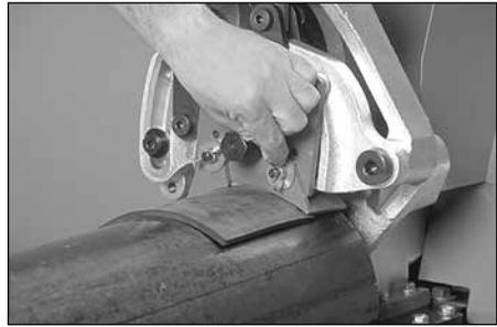
9. Desserrez les écrous à oreilles et réglez chaque protecteur de manière à épouser la forme du tuyau en pinçant la cale légèrement contre le tuyau, resserrez ensuite les écrous à oreilles pour fixer les protecteurs en place. Retirez la cale de réglage des protecteurs
