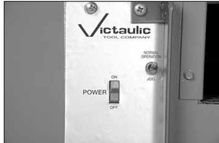
6. Préparez-vous à soutenir le tuyau et placez le commutateur à levier à la position « **NORMAL OPERATION** ». L'ensemble bras/rouleau supérieur retournera alors à sa position la plus haute position et le tuyau sera dégagé.
