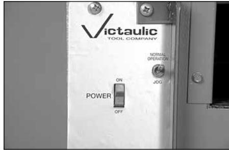
3. Placez le commutateur d'alimentation du côté de l'outil à la position « **ON** » et placez le commutateur à levier à la position « **NORMAL OPERATION** ».
