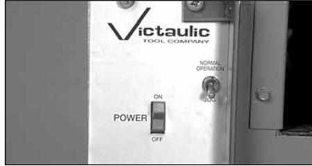
4. Placez le commutateur d'alimentation du côté de l'outil à la position « **ON** » et placez le commutateur à levier à la position « **JOG** ».
