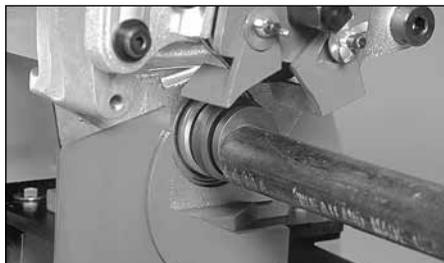
1. Installez une longueur de tuyau de ¾ po/ 26.9 mm à 3 ½ po/101.6 mm de diamètre d'épaisseur adéquate sur le rouleau inférieur de l'outil en vous assurant que l'extrémité du tuyau fasse contact avec le flasque de butée arrière du rouleau.
