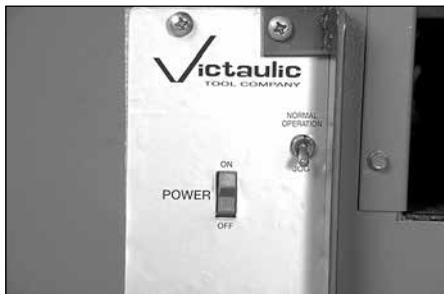
6. Placez le commutateur d'alimentation du côté de l'outil à la position « ON » et placez le commutateur à levier à la position « JOG ».
