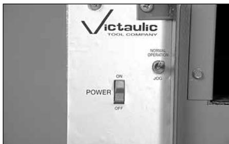
7. Préparez-vous à soutenir le tuyau et placez le commutateur à levier à la position « **NORMAL OPERATION** ». L'ensemble bras/rouleau supérieur retournera alors à sa position la plus haute position et le tuyau sera dégagé.
