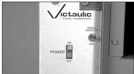
11. Préparez-vous à soutenir le tuyau et placez le commutateur à levier à la position « **NORMAL OPERATION** ». L'ensemble bras/rouleau supérieur retournera alors à sa position la plus haute position et le tuyau sera dégagé.
