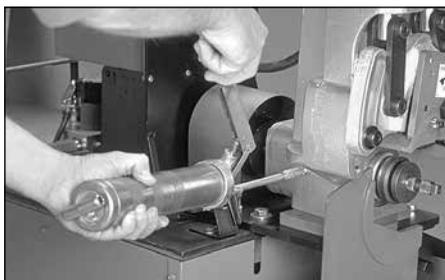
2. Graissez le palier de l'arbre principal par le raccord présent sur le côté de l'outil montré ci-dessus. Pour connaître le type de graisse approprié à utiliser, veuillez vous référer au tableau applicable du chapitre Lubrifiants recommandés.
