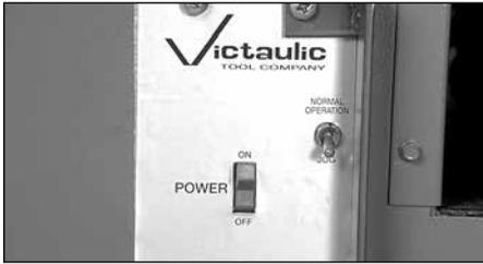
6. Placez le commutateur d'alimentation du côté de l'outil à la position « ON » et placez le commutateur à levier à la position « JOG ».
