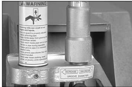
10. Verrouillez le réglage de profondeur de rainure sur l'outil de sorte que le jeu entre la butée et le corps de l'outil soit de 6 mm (¼ po).
