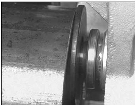
5. Installez une longueur de tuyau de diamètre et épaisseur adéquats sur le rouleau inférieur de l'outil en vous assurant que l'extrémité du tuyau fasse contact avec le flasque de butée arrière du rouleau. Le tuyau doit reposer directement par dessus le rouleau sans former d'angle d'un côté ou de l'autre.
