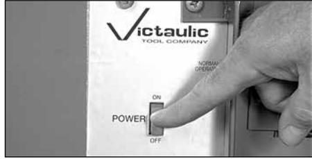
4. Si la rotation du rouleau inférieur est en sens antihoraire, placez le commutateur d'alimentation du côté de l'outil en position « **OFF** » et suivez les instructions ci-dessous.
