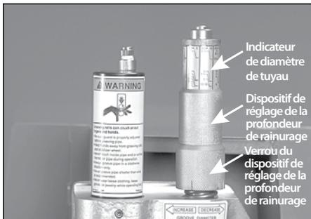
2. Repérez le diamètre et l'épaisseur sur l'indicateur de diamètre de tuyau. Cet indicateur de type barillet tourne pour mieux voir la mesure.
