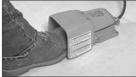
5. À l'aide du commutateur à pédale de la machine, mettez le moteur de l'outil en marche et faites descendre le rouleau supérieur jusqu'il fasse une pression positive sur le tuyau et relâchez la pédale.
