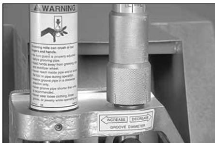
13. Poursuivez le processus de rainurage jusqu'à ce que le barillet de verrouillage du réglage de profondeur de rainurage vienne en contact avec le haut du corps de l'outil et laissez alors le tuyau tourner plusieurs tours afin d'assurer un rainurage complet.
