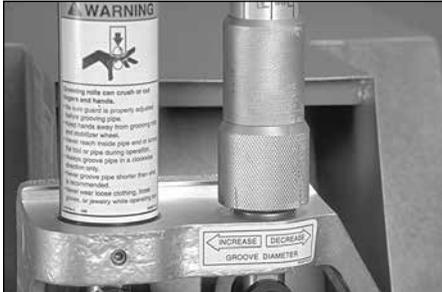
6. Poursuivez le processus de rainurage jusqu'à ce que le barillet de verrouillage du réglage de profondeur de rainurage vienne en contact avec le haut du corps de l'outil et laissez alors le tuyau tourner plusieurs tours afin d'assurer un rainurage complet.
