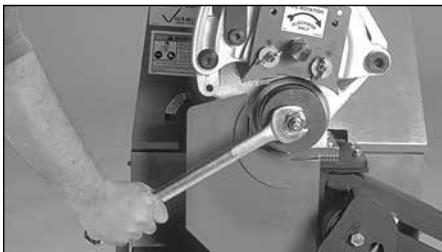
3. À l'aide d'une clé, dévissez le gros écrou du tourillon jusqu'à obtenir un dégagement de ¼ po/6 mm du rouleau. Ne PAS déposer cet écrou.
