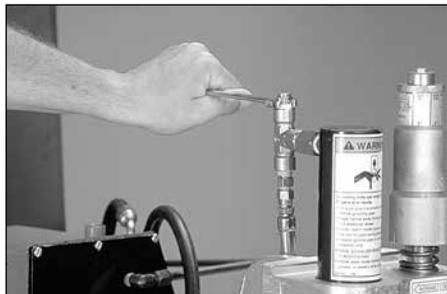
2. Déposez le bouchon du raccord en T, près du vérin hydraulique.
