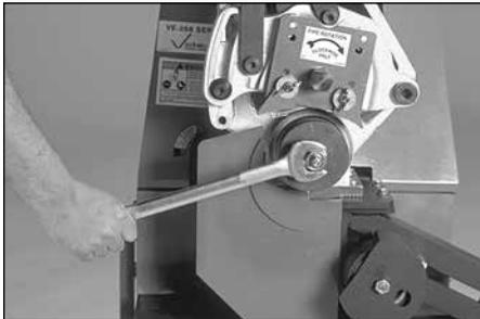
2. Reposez la rondelle plate et le gros écrou sur le goujon fileté du tourillon et serrez fermement l'écrou avec une clé pour fixer le rouleau inférieur en place. Ne serrez PAS l'écrou outre mesure.
