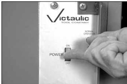
1. Placez le commutateur d'alimentation du côté de l'outil à la position « ON ».
