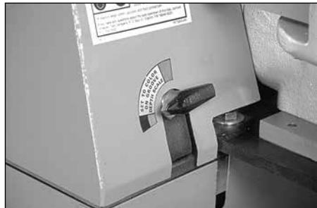
11. Réglez la soupape de sélection de pression à l'avant de l'outil à la position **NOIRE**.
