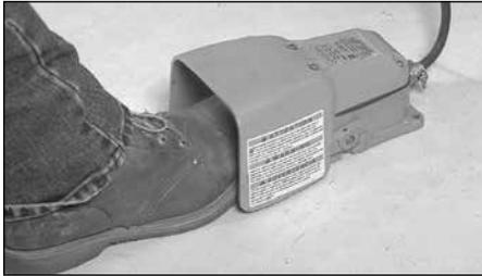
7. À l'aide du commutateur à pédale de la machine, mettez le moteur de l'outil en marche et faites descendre le rouleau supérieur jusqu'il fasse une pression positive sur le tuyau et relâchez la pédale.
