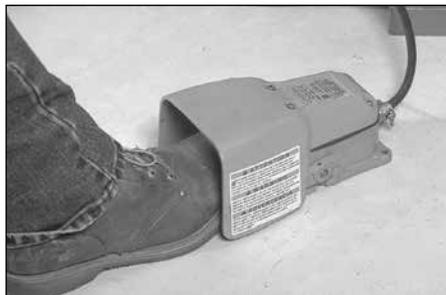
11. Pour démarrer le rainurage, actionnez la pédale d'opération et le rouleau supérieur descendra jusqu'à faire contact avec tuyau et celui-ci se mettra à tourner et la formation de la rainure sera alors entamée.
