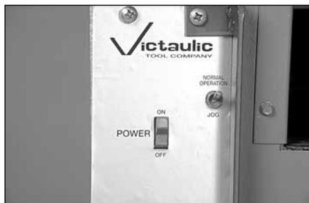
5. Retournez le commutateur à levier du côté de l'outil à sa position « **NORMAL OPERATION** » pour rappeler l'ensemble du rouleau supérieur à sa position la plus élevée.
