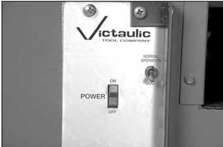
2. Placez le commutateur d'alimentation du côté de l'outil à la position « ON » et placez le commutateur à levier à la position « JOG ».
