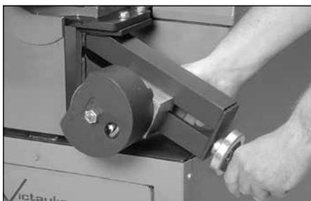
4. Desserrez la poignée de verrouillage du stabilisateur et ramenez le bras d'extension du rouleau stabilisateur à sa longueur minimale (si requis) à l'aide du volant.
