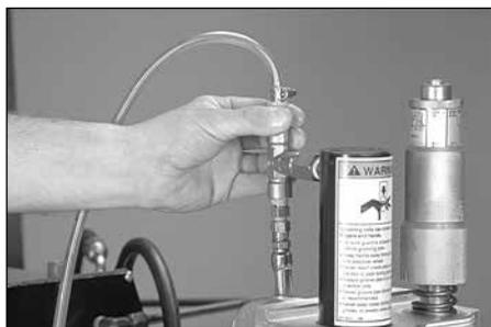
3. Installez le tuyau de purge clair (fourni avec l'outil) en le serrant à la main dans le raccord en T.
