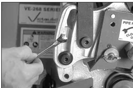
3. Lubrifiez la tringlerie, l'axe de pivotement et les surfaces de glissement du bras. Un lubrifiant pour service dur en aérosol peut être appliqué ou un graissage à la main peut être fait. Pour connaître le type de graisse approprié à utiliser, veuillez vous référer au tableau applicable du chapitre « Lubrifiants recommandés ».
