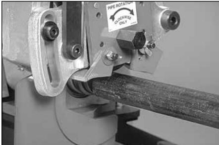
3. En vous tenant sur le côté de la pédale de fonctionnement, soutenez le tuyau manuellement et actionnez la pédale pour faire avancer le rouleau supérieur jusqu'à ce qu'il fasse contact avec le tuyau puis relâchez la pédale et éloignez vos mains du tuyau.
