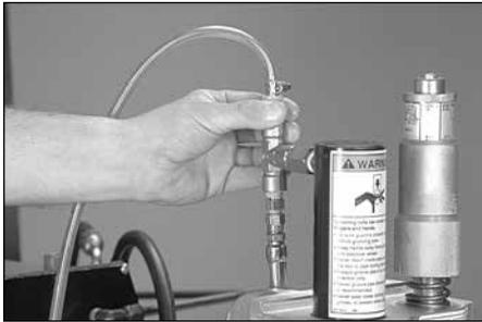
8. Retirez le tuyau de purge du raccord en T et du réservoir. Installez le bouchon sur le raccord en T en prenant soin de ne pas emprisonner d'air sous le bouchon.
