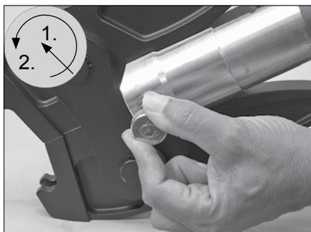
1. Libérer la goupille de verrouillage en appuyant dessus et en la tournant dans le sens des aiguilles d'une montre. Faire preuve de prudence en libérant la goupille de verrouillage. Elle est chargée par ressort. Retirer la mâchoire Vic-Press standard ou la mâchoire adaptatrice Vic-Press de l'outil.
