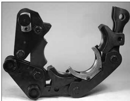
3. Tirer sur la goupille de verrouillage de la bague Vic-Press jusqu'à ce que le bras de la bague Vic-Press soit dégagé. Laisser la bague Vic-Press s'ouvrir complètement, tel qu'illustré ci-dessus.
