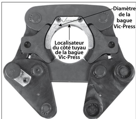
2. Choisir la bague Vic-Press de la dimension correspondante au raccord et au tuyau posé.
