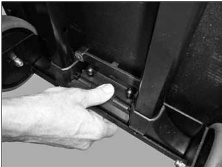
2. Enfoncer le bouton situé au niveau du support inférieur du diable (entre ses roues). Enclencher ce support sur la barre du bas à l'arrière de la mallette à outil ou à accessoires. Relâcher le bouton et vérifier que le diable est bien fixé en place.
