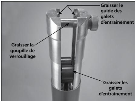
3. Graisser le guide des galets d'entraînement à l'aide d'une graisse légère.
