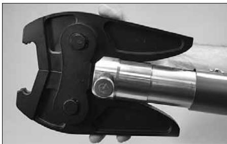
7. Poser la mâchoire Vic-Press standard ou la mâchoire adaptatrice Vic-Press dans l'outil. S'assurer que la mâchoire Vic-Press standard ou la mâchoire adaptatrice Vic-Press est alignée correctement de façon à permettre l'insertion de la goupille de verrouillage.
