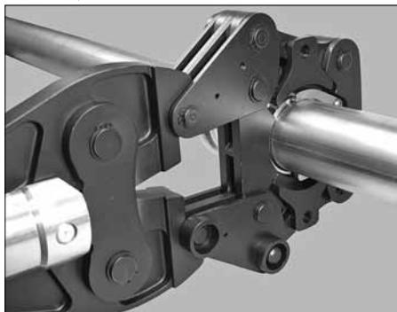
7. Engager les crochets de la mâchoire adaptatrice Vic-Press dans la bague Vic-Press, puis relâcher les leviers. S'assurer que les quatre crochets de la mâchoire adaptatrice Vic-Press soient complètement engagés avec la bague Vic-Press.
