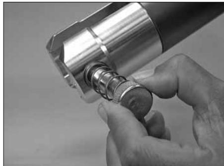
3. Libérer la goupille de verrouillage en appuyant dessus et en la tournant dans le sens des aiguilles d'une montre. Faire preuve de prudence en libérant la goupille de verrouillage. Elle est chargée par ressort.
