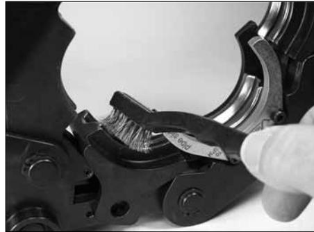
6. Retirer les dépôts des cavités de passage des bagues Vic-Press à l'aide d'une brosse métallique.
