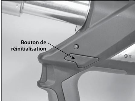
2. La pose d'une mâchoire Vic-Press standard ou d'une mâchoire adaptatrice Vic-Press est possible seulement lorsque les galets d'entraînement sont suffisamment reculés. Au besoin, appuyer sur le bouton de réinitialisation jusqu'à ce que les galets soient reculés.
