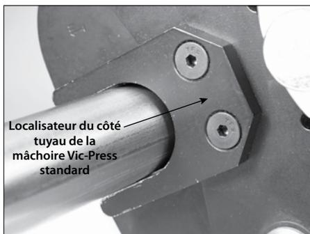
3. Placer la mâchoire Vic-Press standard sur le raccord Vic-Press Schedule 10S en s'assurant que la cavité de la mâchoire Vic-Press standard est alignée avec le cordon du joint d'étanchéité du raccord. L'indication « pipe side » (côté tuyau) de la mâchoire Vic-Press standard doit se trouver au-dessus du tuyau comme montré ci-dessus.
