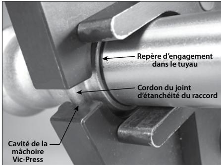
4. Lors du positionnement de la mâchoire Vic-Press standard, s'assurer que le tuyau reste complètement inséré dans le raccord et que la cavité de la mâchoire Vic-Press est alignée et s'emboîte sur le cordon du joint d'étanchéité du raccord, comme montré ci-dessus. L'extrémité du raccord doit être sur le repère d'engagement sur le tuyau. Toujours se reporter au manuel d'installation sur le terrain I-P500 pour obtenir les exigences de préparation et de marquage du tuyau.
