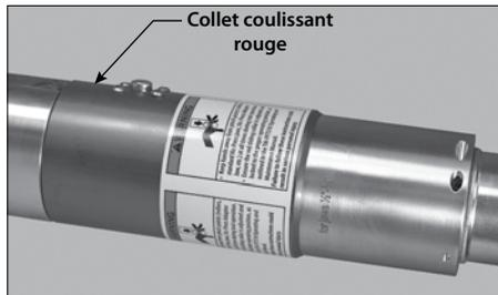
La position montrée ci-dessus (collet coulissant rouge engagé à la position supérieure avant) doit être utilisée pour les diamètres  $\frac{1}{2}$  po/21.3 mm et  $\frac{3}{4}$  po/26.9 mm.
