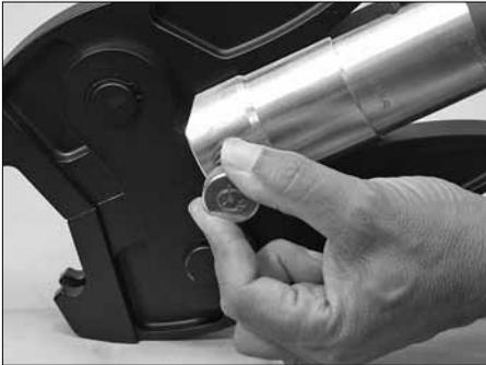
7a. Pousser la goupille de verrouillage complètement dans l'outil jusqu'au déclic.
