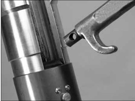
2. Nettoyer les galets d'entraînement et la goupille de verrouillage à l'aide d'une brosse ou d'air comprimé.
