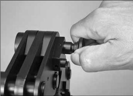
8d. Retirer la bague Vic-Press du raccord en tirant sur la goupille de verrouillage jusqu'à ce qu'elle soit dégagée du bras de la bague Vic-Press, tel qu'illustré à l'étape 3 de ce chapitre.
