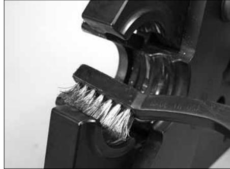
5. Retirer les dépôts des cavités de passage de la mâchoire Vic-Press standard à l'aide d'une brosse métallique.
