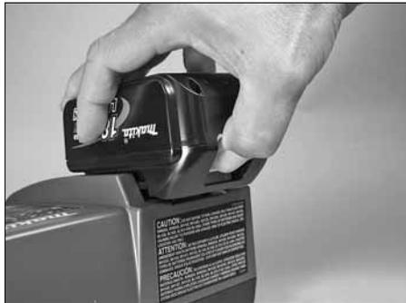
2. Appuyez sur le bouton situé sur le bloc-piles pour le retirer la batterie du chargeur comme montré ci-dessus.
