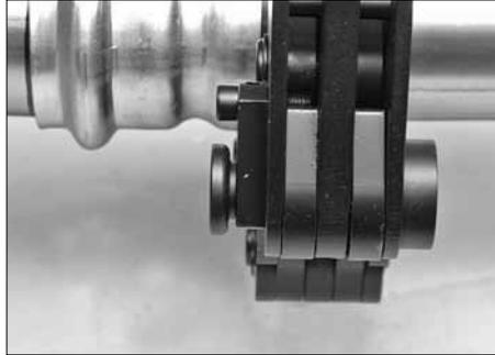
5. Fermer la bague Vic-Press en alignant les orifices à chaque extrémité. Appuyer sur la goupille de verrouillage pour qu'elle traverse complètement le bras de la bague Vic-Press, tel qu'illustré ci-dessus. **REMARQUE** : la bague Vic-Press peut être tournée autour du raccord pour faciliter le positionnement de l'outil.
