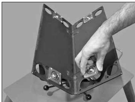
2. Placez les quatre roulements à billes porteurs aux emplacements indiqués sur le schéma présenté au bas de cette page, en fonction de la dimension du tube devant être rainuré.
