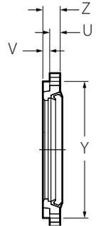
**Note:** Pour une étanchéité correcte, il faut que la zone ombrée de la face d'appui de la contre-bride soit exempte de stries, ondulations ou autres déformations.
