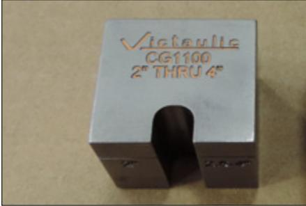
1. Prendre le bloc d'alignement de 2 à 4 pouces. Le diamètre des tuyaux (en pouces) est gravé sur les blocs d'alignement.
