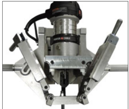
4. Les bras de 2 à 4 pouces doivent être insérés dans l'outil à un angle précis. Faire correspondre les « A » et « B » gravées sur le bras avec les lettres gravées sur le corps de l'outil. Insérer alors les bras dans le corps de l'outil avec les lettres correspondantes face-à-face.
