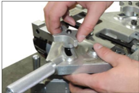
2. Dévisser et déposer les molettes de verrouillage du bras.
