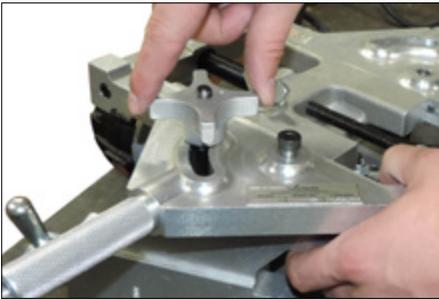
5. Remettre les molettes de verrouillage des bras en place et les visser jusqu'à ce que les bras soient bien au fond du corps de l'outil.
