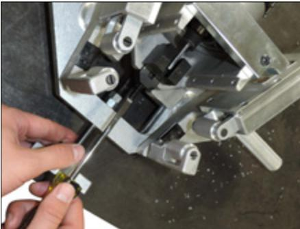
9b. Pour modifier l'emplacement de la matrice de coupe, utiliser le tournevis à lame pour visser la vis de réglage en profondeur jusqu'à ce que l'extrémité de la matrice repose tout juste sur la ligne sélectionnée du bloc d'alignement ou sur cette ligne.
