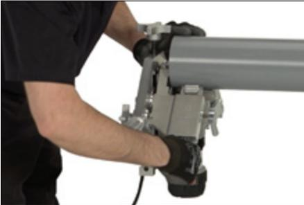
6. Enclencher les leviers articulés puis serrer à la main jusqu'à ce que les rouleaux des diamètres interne et externe touchent la paroi du tuyau. Ne pas trop serrer.
