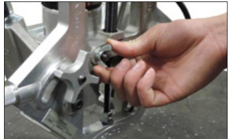
1. Desserrer l'écrou à oreilles sur la vis de réglage « A », située à l'avant de l'outil.
