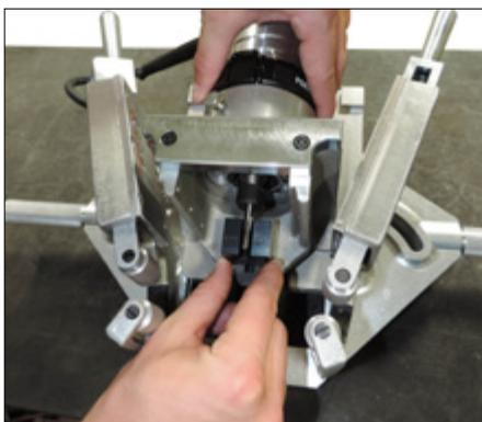
8. Aligner l'encoche à l'arrière du bloc d'alignement avec la butée de profondeur derrière la matrice. Coulisser le bloc d'alignement par dessus la butée de profondeur jusqu'à ce qu'il soit bien enfoncé.
