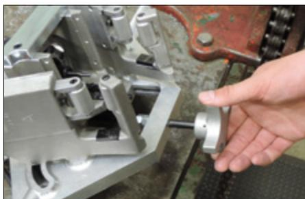
7. À l'aide de la molette de réglage du chariot du moteur, s'assurer que la matrice de coupe est suffisamment haute pour ne pas toucher au diamètre externe du tuyau lorsque vous assemblez l'outil. Tourner la molette en sens antihoraire pour relever la matrice et dans le sens horaire, pour l'abaisser.
