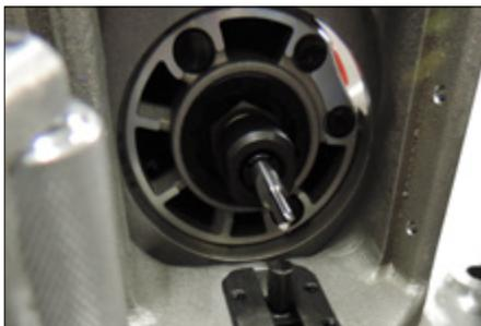
7. Vérifier la bonne profondeur d'insertion de la matrice de coupe. La ligne gravée doit être partiellement ou entièrement recouverte par la bague.
