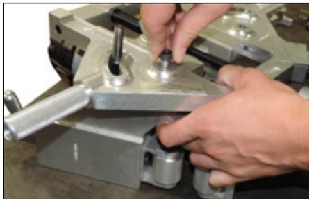
6. Remettre les boulons d'épaulement en place et les serrer avec les doigts.
