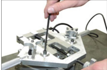
1. Desserrer et déposer les boulons d'épaulement avec la clé hexagonale fournie.
