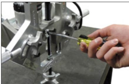
2. Avec un tournevis à lame, tourner la vis de réglage « A » dans le sens antihoraire pour ajuster l'emplacement de la rainure.
