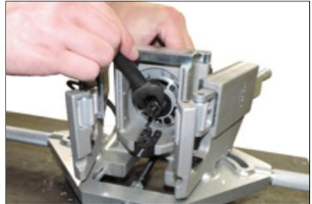
3. Utiliser la clé de 5/8 po pour desserrer la bague tout en enfonçant la touche de verrouillage de l'arbre. Retirer la matrice de 2 à 4 pouces.
