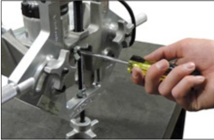
2. Avec un tournevis à lame, tourner la vis de réglage « A » dans le sens horaire pour ajuster l'emplacement de la rainure.
