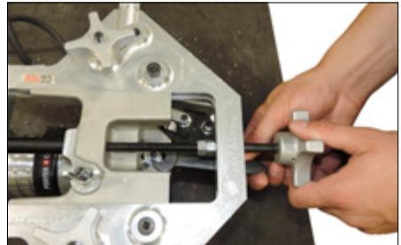
11. Serrer à la main l'écrou de verrouillage de la butée de profondeur. Ne pas trop serrer.
