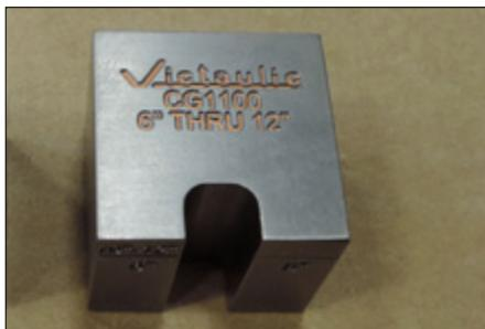
1. Retirer le bloc d'alignement de 6 à 12 pouces. Le diamètre des tuyaux (en pouces) est gravé sur les blocs d'alignement.
