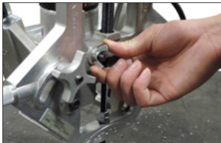
1. Desserrer l'écrou à oreilles sur la vis de réglage « A », située à l'avant de l'outil.
