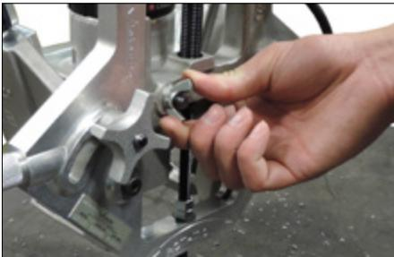
4. Serrer l'écrou à oreilles sur la vis de réglage « A », située à l'avant de l'outil.
