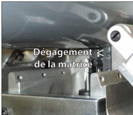
7. Relever la matrice en tournant la molette de réglage du chariot du moteur en sens antihoraire jusqu'à qu'elle soit complètement dégagée au moment de retirer du tuyau.
