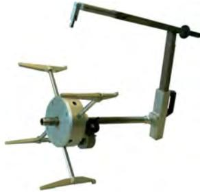
Le racloir RTC-710 se prête à la préparation des extrémités de tubes dans la gamme des grandes dimensions (d 355-710 mm). L'appareil garantit une qualité de raclage régulière sur une longueur de travail jusqu'à max. 530 mm et convient pour les tubes en PE 80 et PE 100.
