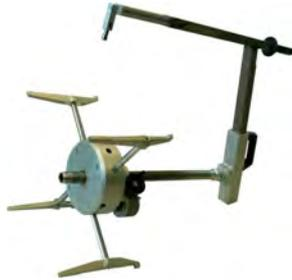
L'outil grattoir COOL-FIT RTC-315 est adapté pour gratter des tubes en ABS pré-isolés du système FIT COOL. Contenu de la livraison: 1 bras "Scraper", 1 base auto-centrage, 1 mallette de transport en Aluminium, 1 tournevis, 1 couteau d'ébavurage.
