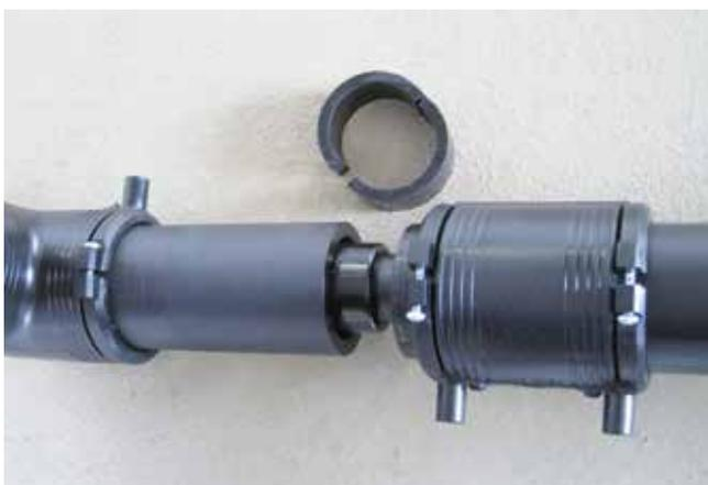
L'assemblage séparé des tuyaux intérieurs et extérieurs permet d'effectuer un test de fuite sur la conduite de transport d'un milieu avant de fermer le tuyau extérieur. Les joints de fusion peuvent être contrôlés au moment où ils sont effectués. Le système de tuyauteries à confinement double est donc conçu de manière similaire à un système monotube.
